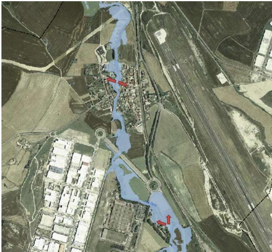
Figura 9. Secciones de desbordamiento (flechas rojas)
